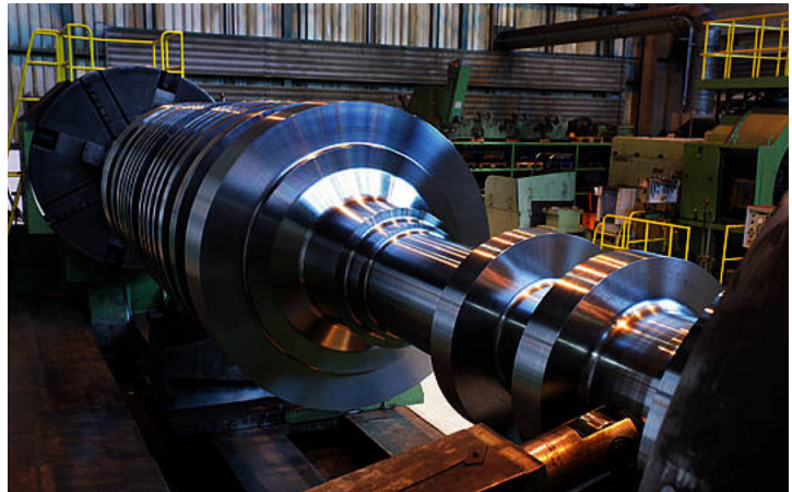
Bild 5: Die gewaltigen mit 3.000 Umdrehungen pro Minute rotierenden Schwungmassen der Generatoren können innerhalb von Millisekunden einen Teil ihrer Rotationsenergie als elektrische Energie in das Netz einspeisen.
