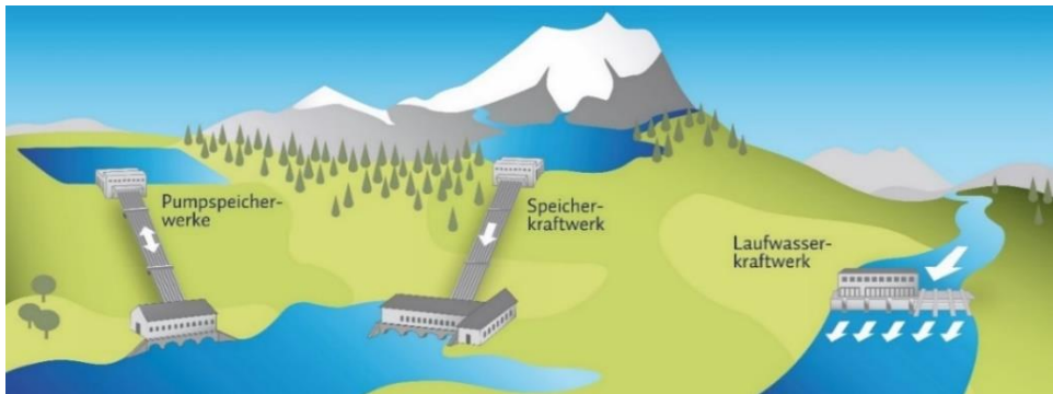
Bild 10. Möglichkeiten, Wasserkraft in CO 2 -freien Strom umzuwandeln
