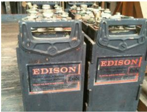
Bild 2. Alkalischer Eisen-Nickel-Akkumulatoren von Alva Edison 3
