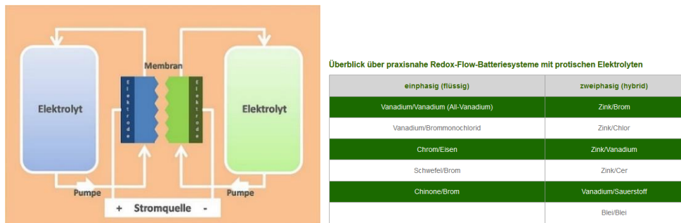
Bild 64. Überblick und prinzipieller Aufbau von Redox-Flow-Batterien 89
