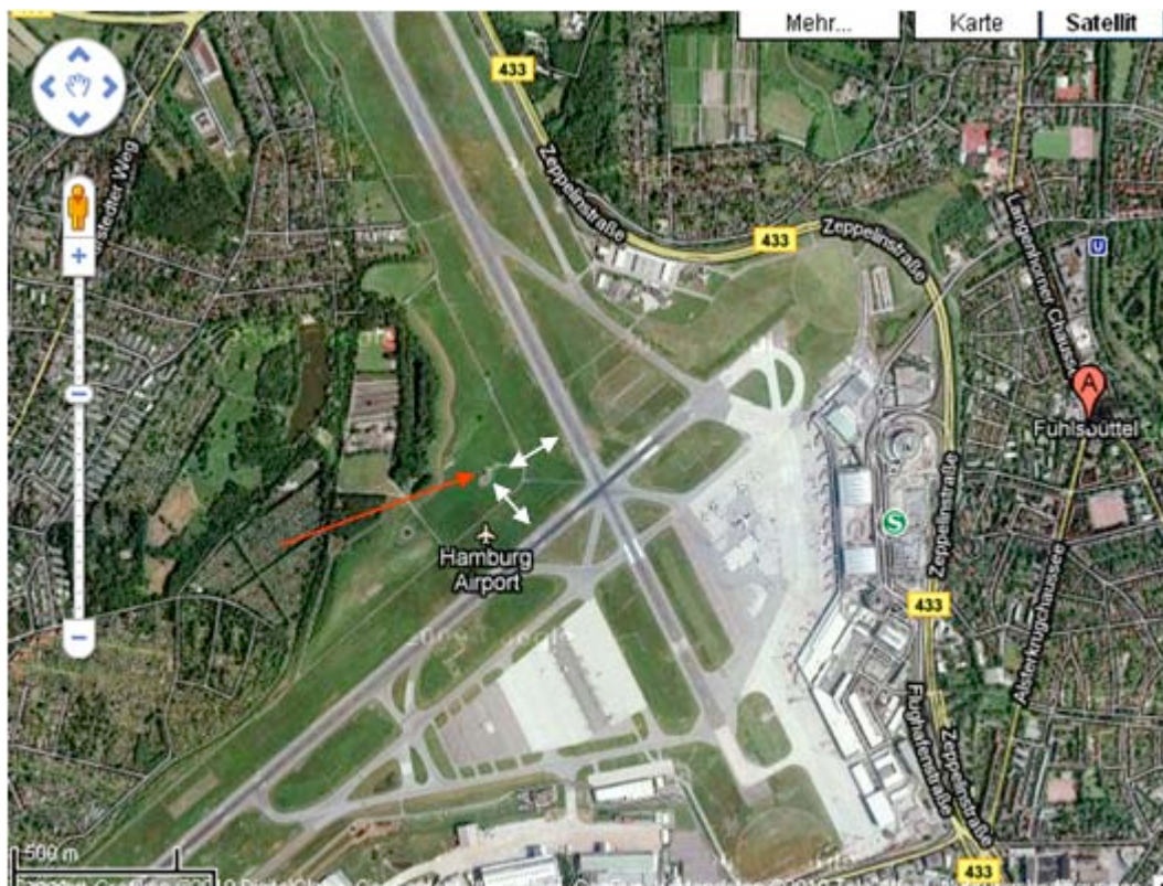
Die Übersichtsaufnahme zeigt die DWD-Wetterstation in Relation zu beiden Start und Landebahnen (roter Pfeil). Mit ca. 200m Abstand ist auch diese Station viel zu nahe zu den startenden und landenden Jets. Immerhin könnte man dem DWD zu Gute halten, das er darauf achtete, dass die Station gleich weit zu beiden Start-/Landebahnen entfernt ist (weiße Pfeile), d.h. die Station wird von beiden Seiten gleichmäßig mit heißen Abgasstrahlen auf Grund der Wirbelschleppen beaufschlagt.
