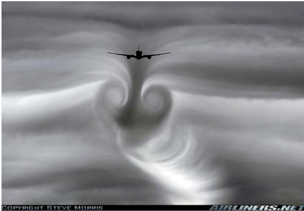
Abbildung 13 zeigt die Luftverwirbelung und deren Ausbreitung bei einer anfliegenden Boeing 777.
