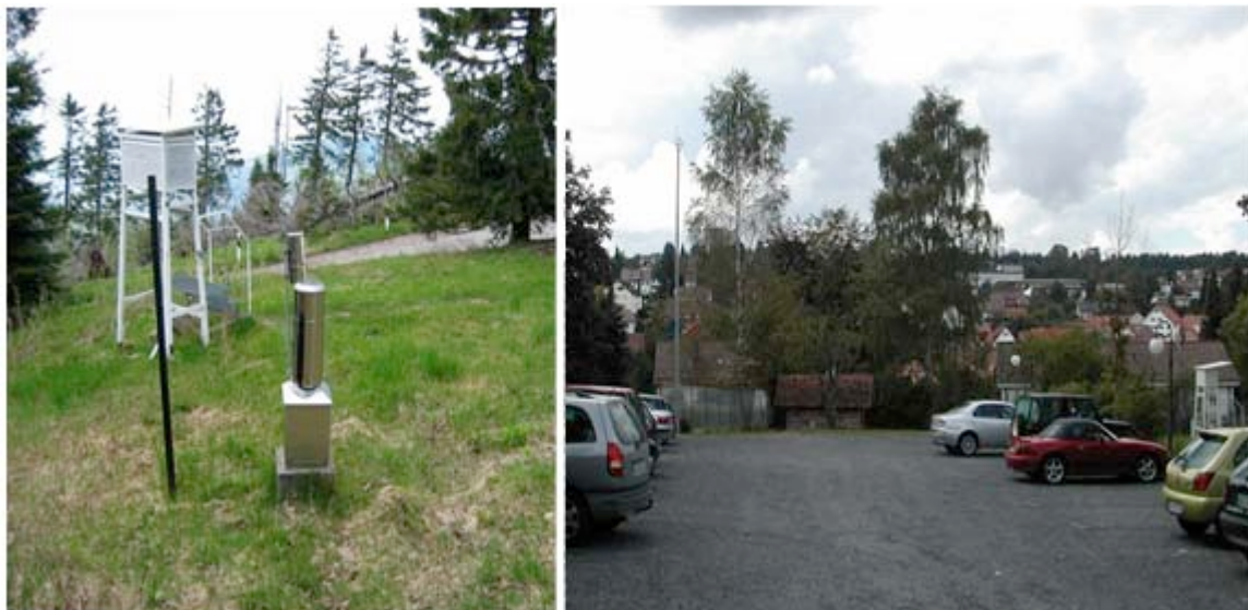
Abbildung 18: Links, Hornisgründe, Bewertung: Nicht geeignet, da in unmittelbarer Nähe zum Waldrand und am oberen Hang einer größeren Anhöhe gelegen. Wärmebeeinflussung durch Thermik. Rechts, Schömburg, Bewertung: Nicht geeignet, da zu nahe an einem Parkplatzes gelegen – Fahrzeugabwärme.
