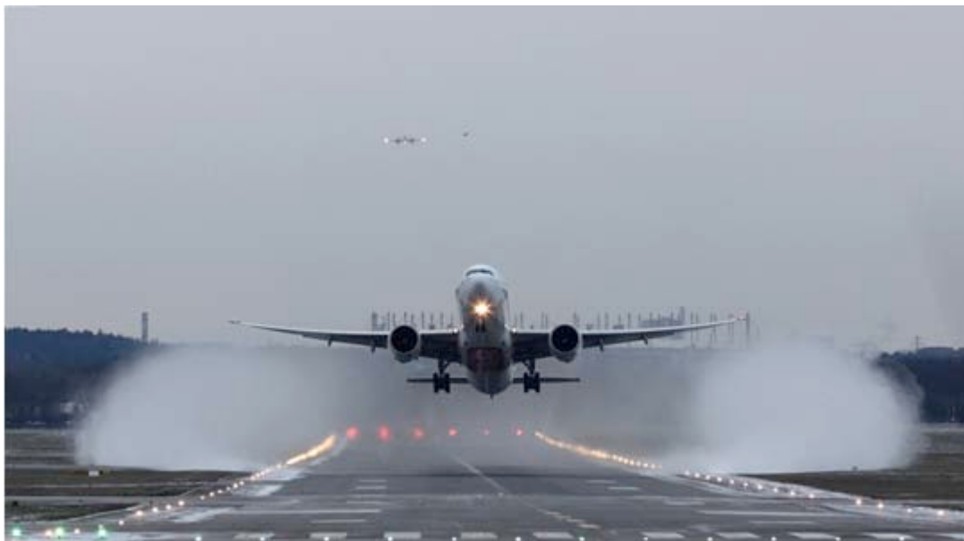
Abbildung 10 zeigt die Luftverwirbelung und deren Verteilung bei einem kleineren, startenden Verkehrsflugzeug.
