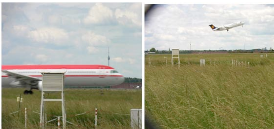
Abbildung 16: Stuttgart Flughafen, Bewertung: Nicht geeignet, da viel zu nahe an der Startbahn gelegen.
