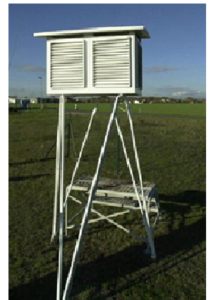
Abb. 4 : Wetterhütte zur Messung der bodennahen Lufttemperatur
