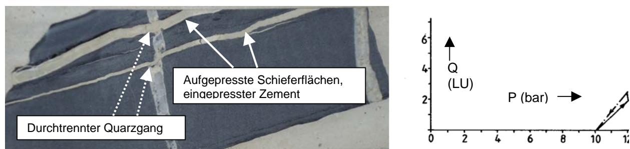
Abb. 5: Zementsteinlagen in aufgepressten Schieferflächen trennen quarzgefüllte Klüfte; kritischer Druck P_{crit} \leq 12 bar
