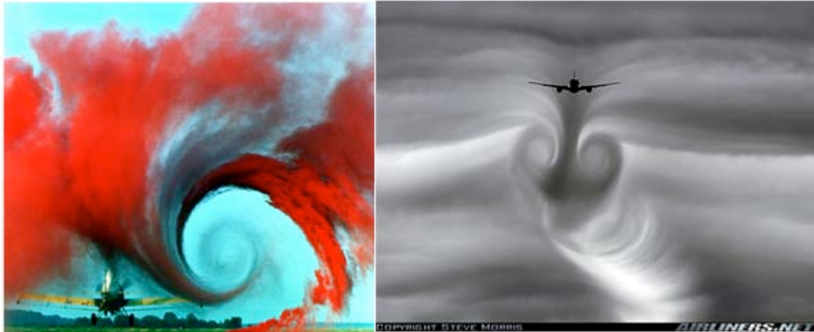
Abbildung 12 links, Quelle: NASA, zeigt am Beispiel eines Kleinflugzeugs recht anschaulich, wie solche Wirbelschleppen die Luftschichten hinter sich regelrecht durchquirlen. Abbildung rechts zeigt, die Luftverwirbelung und deren Ausbreitung bei einer anfliegenden Boeing 777.
