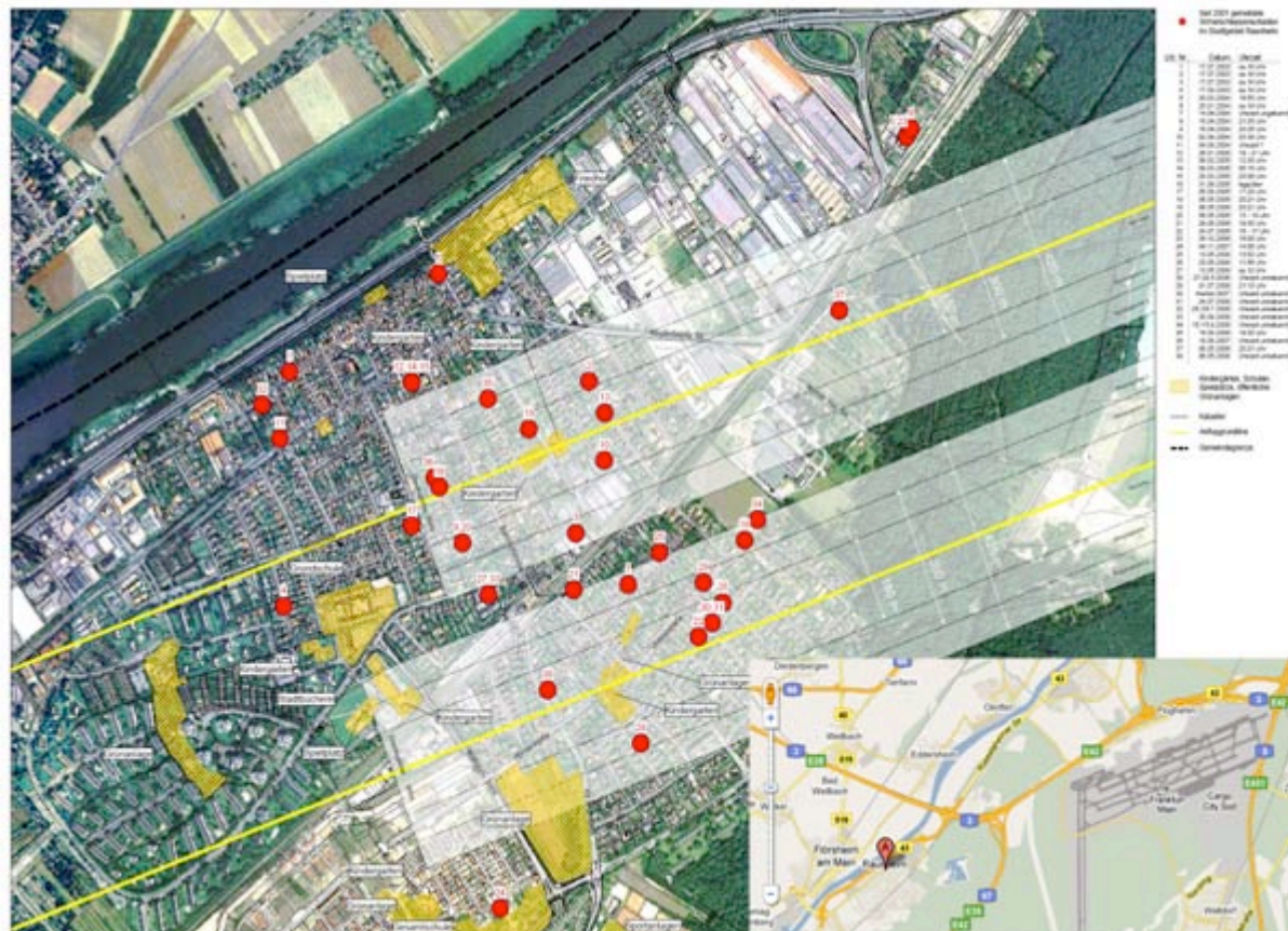
Abbildung 13 zeigt anhand der Wirbelschleppenschäden im Stadtgebiet Raunheim, Quelle: ( http://www.bi-fluglaerm-raunheim.de/wirbelschleppen.htm ) das Ausbreitungs- oder auch Einzugsgebiet von Wirbelschleppen und die kleine Abbildung die Lage Raunheims (A) zum Flughafen Frankfurt. Die Abbildung belegt, dass das Einzugsgebiet ganze Stadtteile umfasst.
