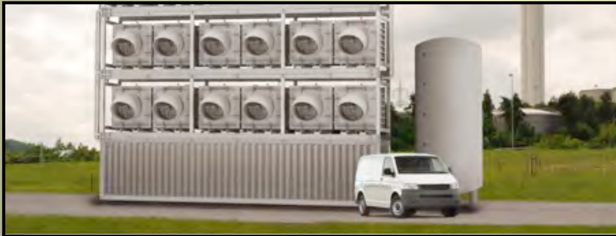
Pilotanlage in der Schweiz: Der Luft 900 Tonnen Kohlendioxid im Jahr entziehen
