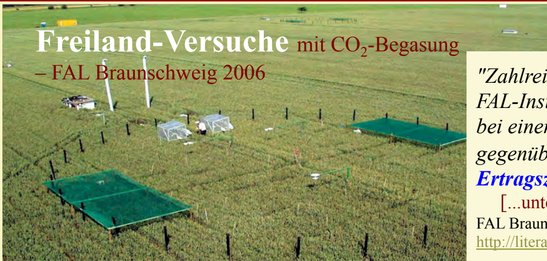
Abb. 1: FAL-Versuchsgelände in Braunschweig: Ansicht eines Begasungsringes für CO 2 -Anreicherungsversuche im Feld (Durchmesser 20 m).
