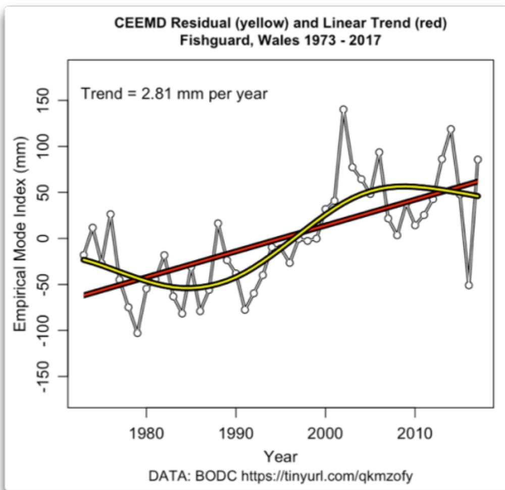
Abbildung 3: Eine CEEMD-Analyse der Tidendaten aus Fishguard in Wales.
