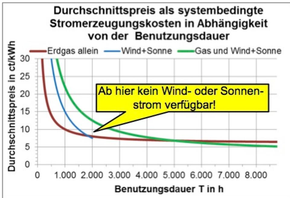
Für typische Werte  $p_L = 40 \text{ €/kW}$  und  $p_a = 6 \text{ ct/kWh}$  für Gaskraftwerke bzw.  $p_L = 150 \text{ €/kW}$  und  $p_a = 0 \text{ ct/kWh}$  für den Wind-/Solaranlagenmix ergibt sich die nebenstehende Abhängigkeit des Durchschnittspreises von der Benutzungsdauer der Leistung.
