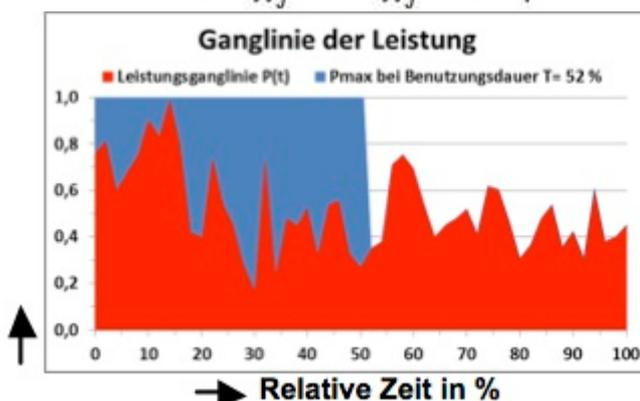
Der Durchschnittspreis wird verursachungsgerecht aus dem beanspruchten Leistungsmaximum im Jahr (in der Regel gebildet aus den beiden höchsten  $\frac{1}{4}$  h Maxima in unterschiedlichen Monaten) und der übers Abrechnungsjahr entnommenen elektrischen Arbeit in kWh bestimmt.  $p_L$  bildet die leistungsabhängigen Kosten in €/kW und  $p_A$  bildet die Arbeitskosten in ct/kWh ab.
