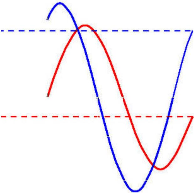
**Bild 1.** Würden zwei Generatoren mit derartiger Phasenverschiebung gleichzeitig ins Netz einspeisen, so würden sie sich gegenseitig beschädigen (Grafik: Saure, Wikipedia Creative Commons)
