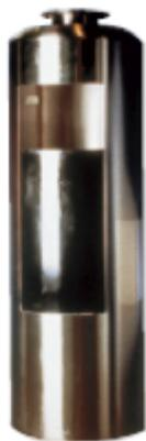
Die Bilder Links zeigen die Abfüllung einer Mischung aus Borsilikatglas versetzt mit hochradioaktivem Müll in der Wiederaufbereitungsanlage in La Hague, sowie einen der verwendeten Edelstahlbehälter in denen diese Masse eingeschmolzen wird
