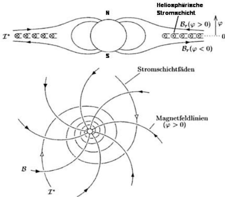
Abbildung 96 nach Alfvén, 1981, zeigt die Heliosphärische Stromschicht und das zugehörige Magnetfeld im Meridionalschnitt und in der Aufsicht von Norden (magn. Südpol). Die Ströme fließen dabei entlang logarithmischer Spiralen (archimedische Spiralen), die senkrecht der magnetischen Feldlinien verlaufen. Adaptiert von "Physik des erdnahen Weltraums", Prof. Gerd W. Pröls, Universität Bonn.
