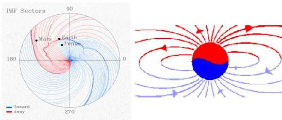
Abbildung 101: Die Feldlinien des Interplanetarischen Magnetfeldes weisen in ihrem Verlauf einmal von der Sonne weg (away, positive Polarität) und einmal zur Sonne hin (toward, negative Polarität, oben). Entsprechend richtet sich die Polarität des Interplanetarischen Magnetfeldes in eine Nord- und Südpolkomponente aus, rechts. Dazwischen verläuft die HCS. Abbildung 101 links zeigt schematisch das spiralförmige Magnetfeld in vier Sektoren unterteilt.
