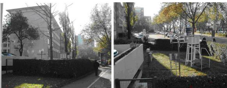
Abbildung 14: Freiburg, Bewertung: Gänzlich ungeeignet, da in unmittelbarer Nähe zu einem mehrgeschossigen Gebäude, einer vielbefahrenen Straße und eines Parkplatzes.
