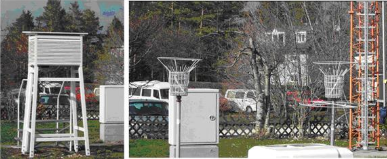
Abbildung 16: Stuttgart Flughafen, Bewertung: Nicht geeignet, da viel zu nahe an der Startbahn gelegen.
