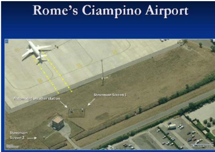
Abbildung 8 zeigt die Temperaturmessstation auf dem Flughafen von Rom und dessen Lage zum Rollfeld.
